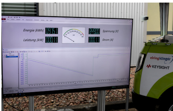
Abbildung 3: Im Rahmen der Abschlusspräsentation des Forschungsprojektes wurde das B0mobil „live“ geladen. Die genauen Messwerte des Ladevorgangs sind auf dem Monitor ablesbar.
