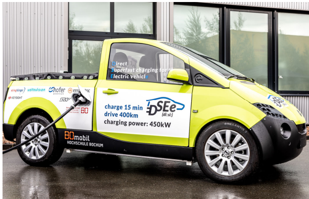
Abbildung 1: Das B0mobil wurde eigens für das Forschungsprojekt „D-SEe“ mit einer neuen und leistungsstarken Batterie ausgerüstet, um den Schnellladevorgang von 15 Minuten für 400 km Reichweite zu ermöglichen.
